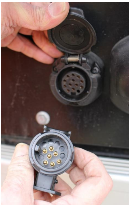
Véhicule avec prise 13 broches et adaptateur 13-7 broches
