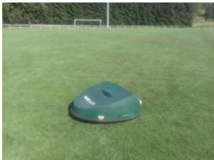
Les 2 terrains d'honneur et d'entraînement ont été équipés chacun d'un robot de tonte électrique, géo-localisé. Ce matériel est loué à une société qui en assure la maintenance. Les tontes sont programmées en fonction des plannings des clubs quelque soit la météo. ■
